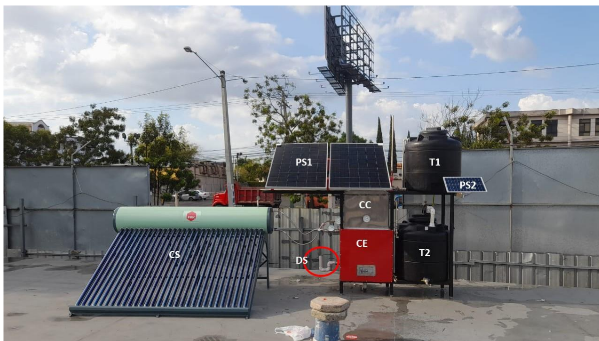
Figura 1: Desalinizador solar en la plataforma experimental del INTEC. T1: Tanque de agua salada; T2: Tanque de agua destilada; DS: Desagüe de salmuera; CC: Cámara de condensación; CE: Cámara de evaporación; CS: Calentador solar; PS1: Paneles solares para la alimentación de la bomba de agua; PS2: Panel solar para la alimentación del soplador del T2.
