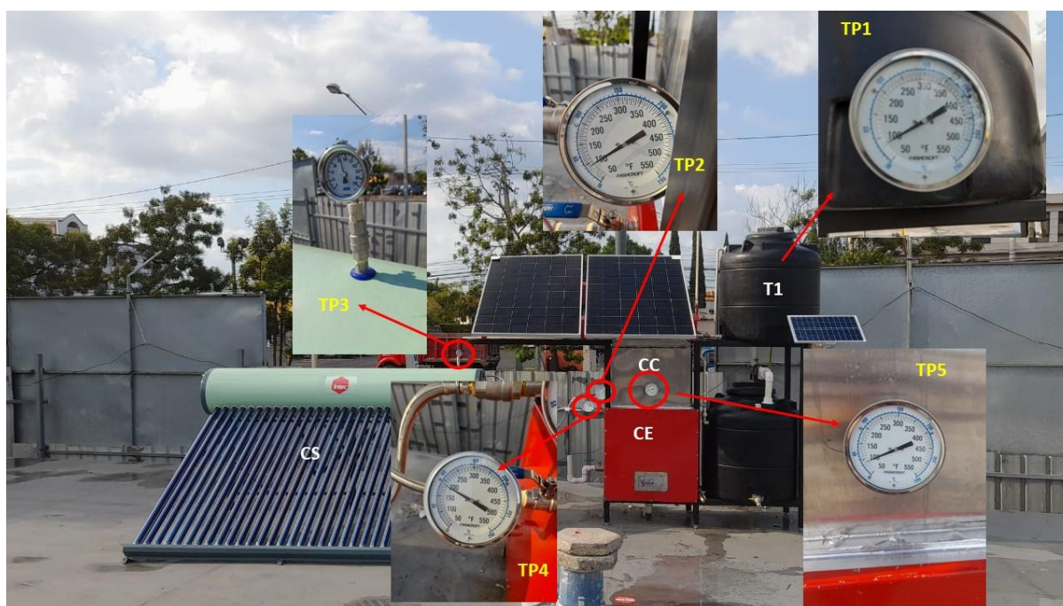
Figura 2: Termómetros para la medición de la temperatura. T 1 : termómetro en el (2) (en la parte de inferior trasera del depósito); T 2 : termopar en la CC. T 3 : termómetro a la salida del serpentín de la cámara de condensación entre (3) y (4); T 4 : termómetro en el calentador; T 5 : Termómetro a la entrada de la cámara de evaporación, entre (4) y (5).
