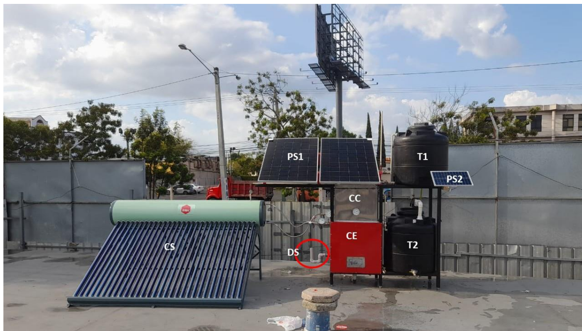
Figura 18: Desalinizador solar en la plataforma experimental del INTEC. T1: Tanque de agua salada; T2: Tanque de agua destilada; DS: Desagüe de salmuera; CC: Cámara de condensación; CE: Cámara de evaporación; CS: Calentador solar; PS1: Paneles solares para la alimentación de la bomba de agua; PS2: Panel solar para la alimentación del soplador del T2.
